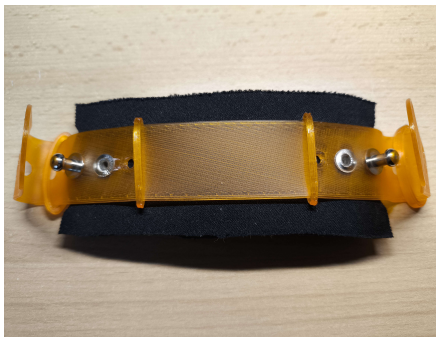
7 mm Einzelkopf-Nieten (für Fesselriemen)
